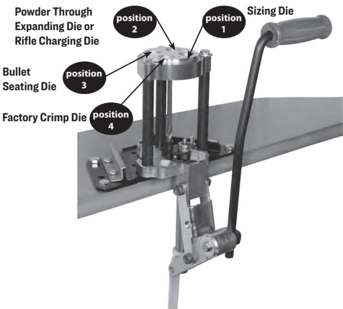
**5 INSTALL LEVER PRIME ASSEMBLY & SHELL HOLDER**
